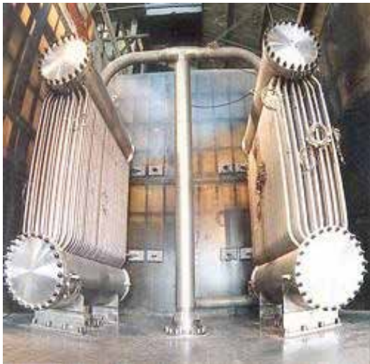
Figura 2 - Passive Containment Cooling Heat Exchanger, prototipo Ansaldo Nucleare per SBWR testato in SIET, Piacenza
