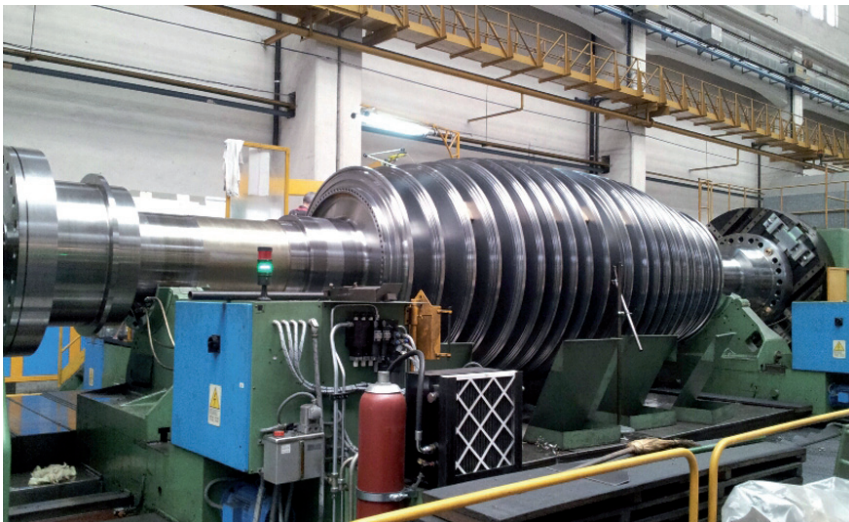
Fig. 3 - Lavorazione di un rotore nuovo della turbina (stadio di bassa pressione)
