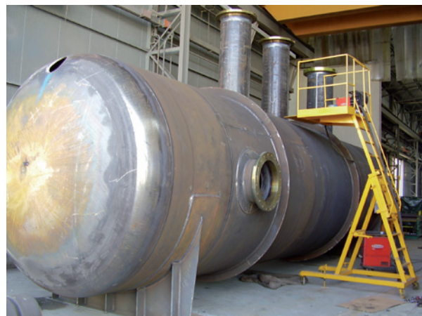
Pressure Vessel in costruzione per progetto KPPC
