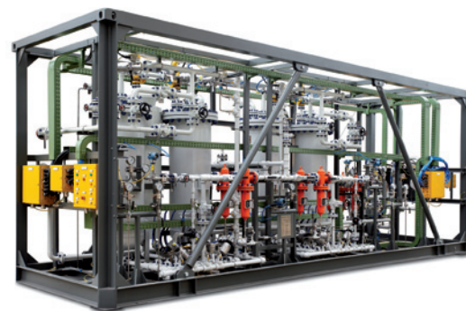
Skid di impianto per la produzione di azoto (processo PSA)
