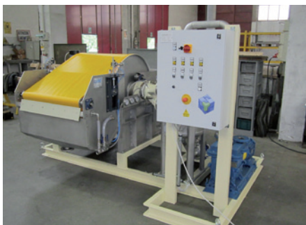
Filtrazione polpa zucca - Filtro Rotativo sottovuoto a tela uscente (2,5 m 2 )
