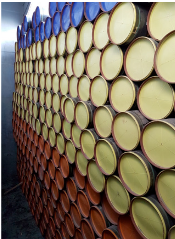
Tubi disposti a nido d'ape nella stiva. Il colore del tappo indica le differenti dimensioni dei tubi
