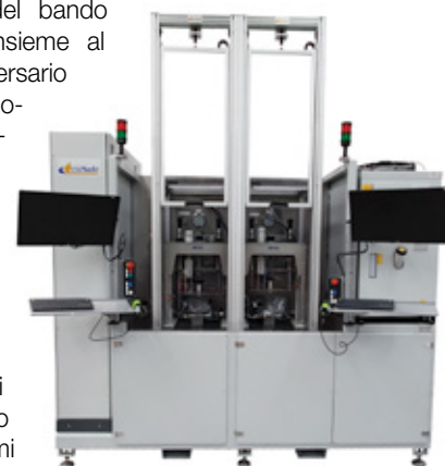
Banco di collaudo valvole di massima pressione con taratura e serraggio automatici
